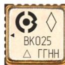
Рисунок 2. Внешний вид микросхемы 5400BK025
